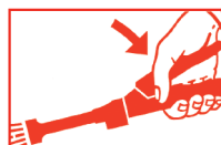
Löschpistole auf Brandherd richten und betätigen
